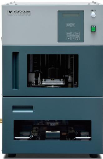
本機は3つの洗浄槽において、超音波と回転による洗浄と遠心分離による液きり、温風（冷風）による乾燥機で構成された時計・精密部品洗浄用途の自動洗浄機です。
